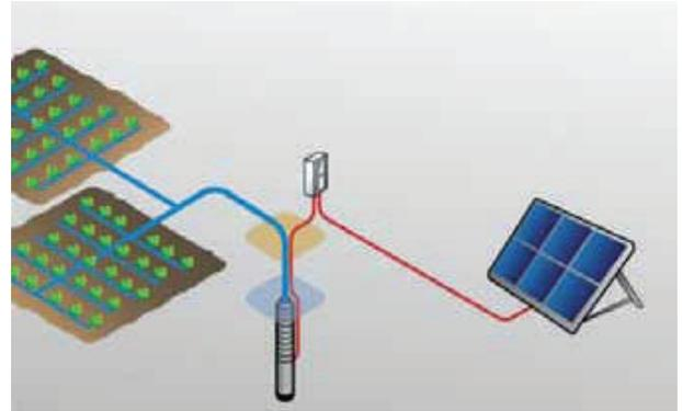
***Forniamo pompe che arrivano fino a 30kw con sistema solare normale (pannelli solari, inverter e pompa). Con 30 kw forniamo 492 m<sup>3</sup>/h per otto ore giornaliere. Considerando che abbiamo un minimo di 12 ore di sole produttive al giorno si supera di gran lunga i 730 m<sup>3</sup> equivalenti a 730 000 litri giornalieri.***
