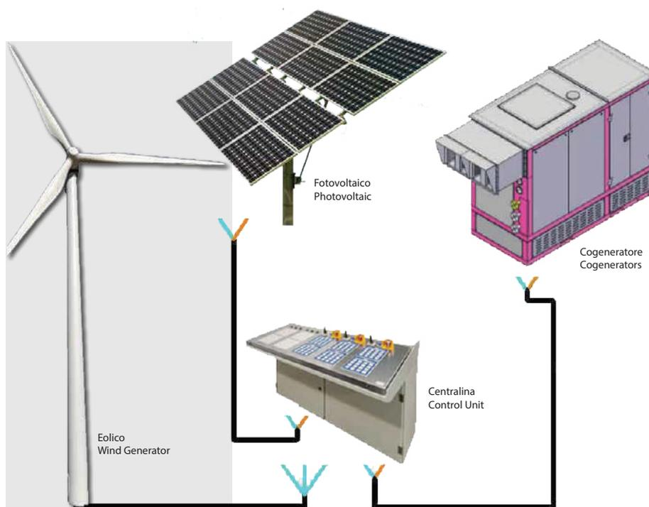
È possibile fornire energia elettrica a consumatori non raggiunti dalla rete attraverso sistemi off-grid. L'elettificazione di aree rurali può essere realizzata con sistemi ad isola oppure allacciati a rete: affidabili, economici e semplici da realizzare. Tali sistemi combinati sono più funzionali allacciati alla rete in quanto l'energia in eccesso viene immessa direttamente nella rete elettrica, alcuni esempi d'impiego possono essere:
